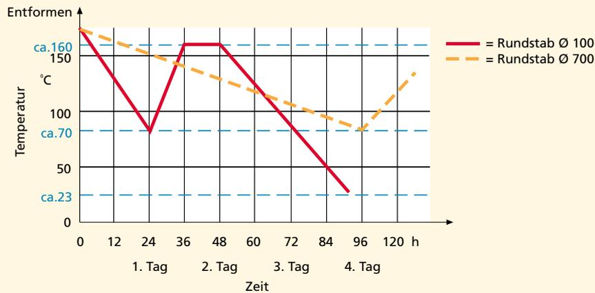
Es wird erkennbar, dass ein Vollstab mit Ø 100 mm bereits einen Tag nach dem Entformen soweit abgekühlt ist, dass er getempert werden kann. Dagegen benötigt ein Vollstab mit Ø 700 mm mindestens vier Tage, bis er soweit abgekühlt ist, dass mit dem Temperprozess begonnen werden kann.
